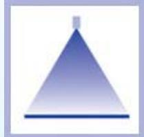
Равномерное распределение жидкости и давления в плоской струе. Благодаря внутренней геометрии форсунки создается компактная управляемая струя.
