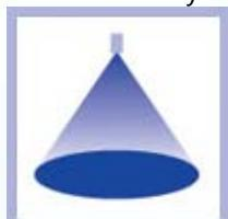
Крайне равномерное распределение по поверхности в виде круга при очень стабильном угле распыла.
