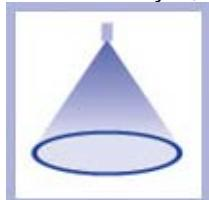
Исключительно равномерное распределение жидкости по поверхности в виде кольца. Самое тонкое распыление, которое можно достичь без помощи воздуха.
